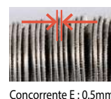
Comparação do Passo do Cavaco Gerado pela Aresta Interna (Avaliação Interna)
