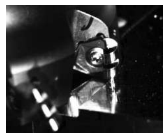
Cavacos Adequadamente Curvados (Foto Tirada por uma Câmera de Alta Velocidade)
